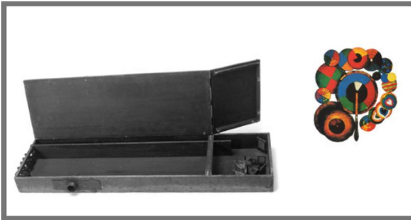
Figura 2: Instrumentos de observación para estudiar el comportamiento del color luz y la visión del color. Caja de Luz y Molinetes de colores diseñados por James Clerk Maxwell.
